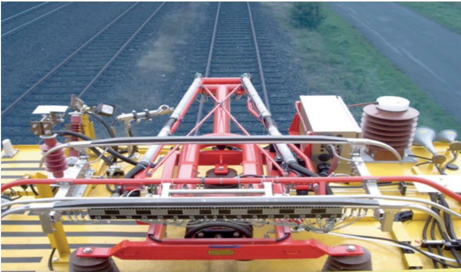
Abb. 22: Komponenten des Fahrdrabtmesssystems FDMA
