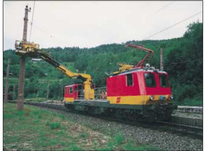
Abb. 9: MTW 100 mit frei verschwenkbarer Hubarbeitsbühne
