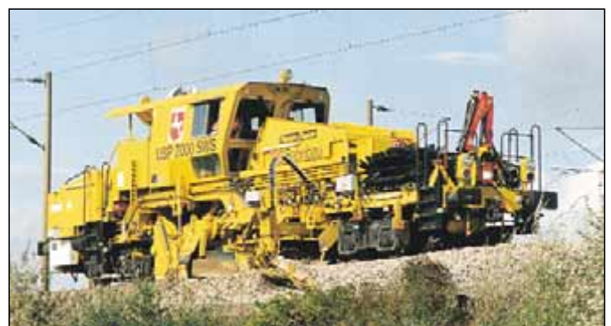
Abb. 3: Universal-Schotterverteiler- und Planiermaschine USP 2000 SWS im Einsatz bei DB-Bahnbau
