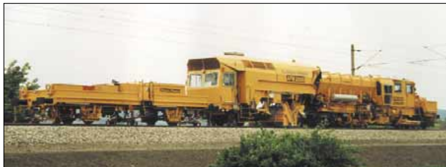
Abb. 5: Automatische Fahrweg-Kontroll-Maschine AFM 2000 im Einsatz bei den Österreichischen Bundesbahnen
