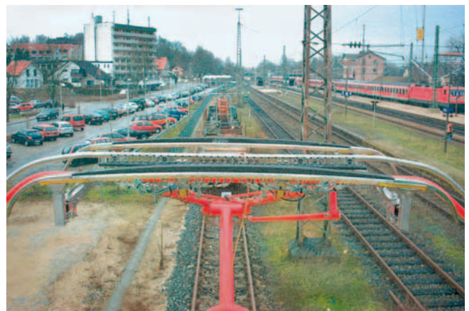
Bild 12: Messstromabnehmer mit Näherungssensoren.
