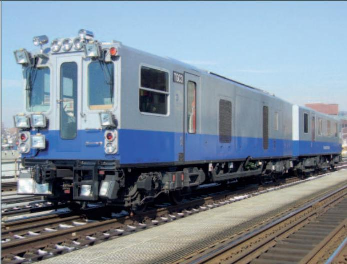
**BILD 4:** Zweiteiliges Gleisgeometriemessfahrzeug TGC3
