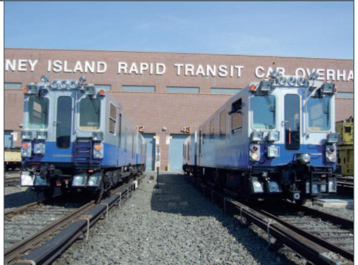
**BILD 5:** Gleisgeometriemessfahrzeuge TGC3 und TGC4
