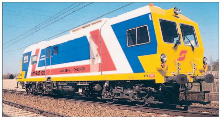
BILD 9: EM-SAT 120 mit Schotterprofilmesssystem
