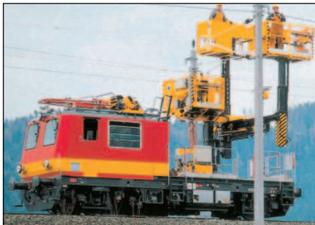
Abb. 3: Montageturmwagen mit dreigeteilter Säulenhebebühne
