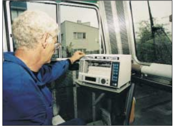
Abb. 6: Justierung einer Messschreiberanlage
