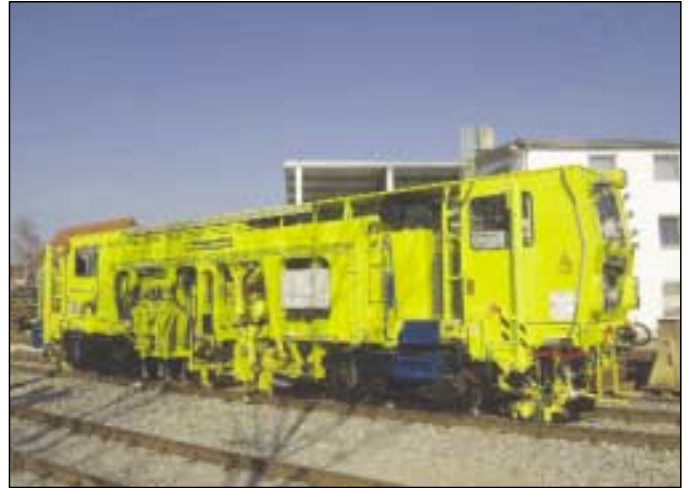
Abb. 4: Universalstopmaschine 08-275/4ZW nach der Reparatur
