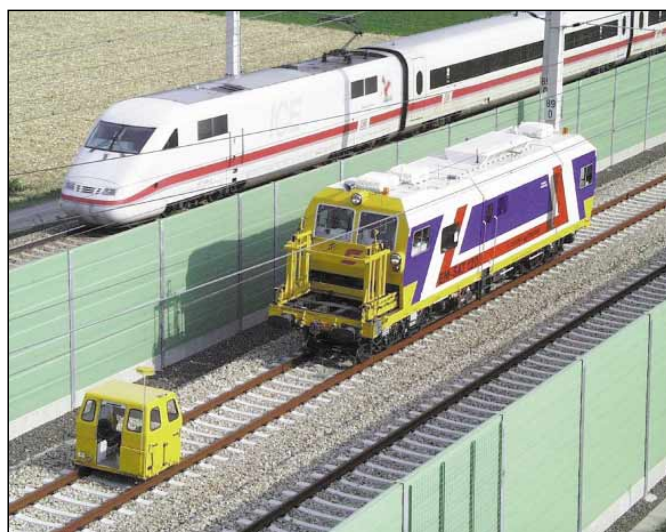
Abb. 1: Gleisvormesswagen EM-SAT 120 – eingesetzt bei den ÖBB
