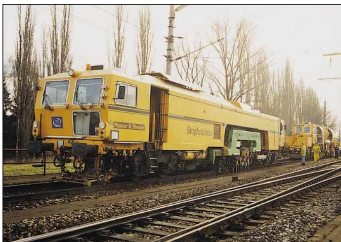
Abb. 2: Mechanisierter Durcharbeitungszug MDZ 2000 im Unternehmereinsatz für die ÖBB
