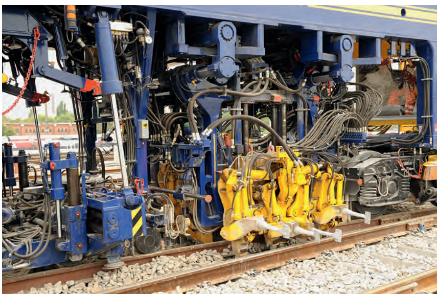
Bild 4: Duomatic-Stopfaggregat mit Schwenkpickeln
