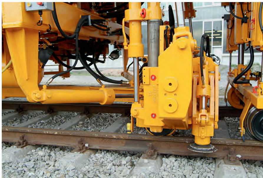
Bild 1: Kombiniertes Hebe- und Richtaggregat mit einer Rollenhebebezüge, Richtrolle und Hebehaken
