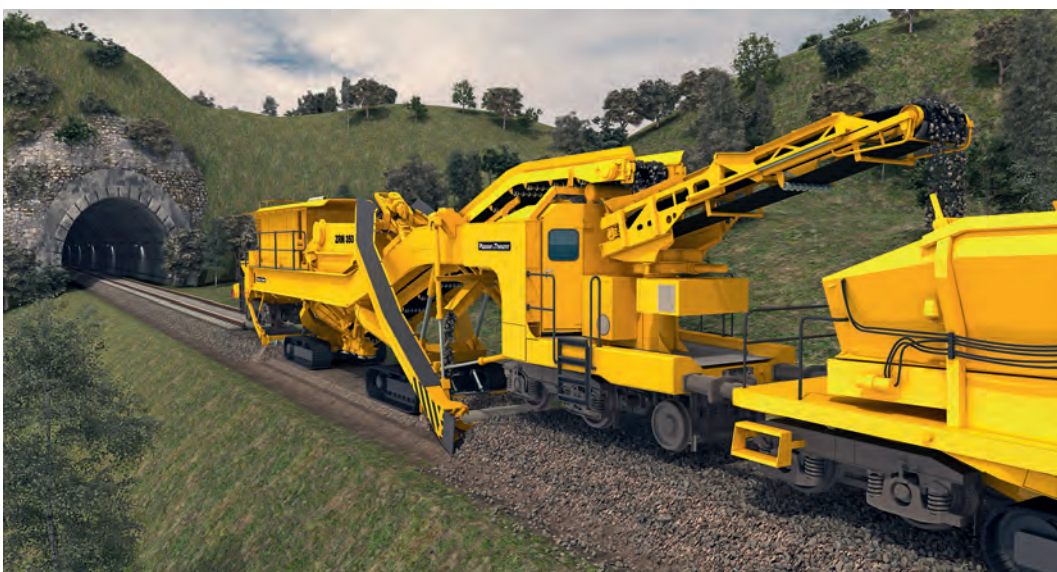
Bild 13: Aufbau der Maschine im gleislosen Bereich
