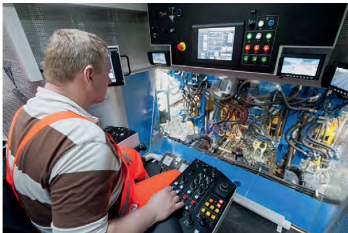
■ Bild 8: Stopfkabine – freie Sicht auf den Arbeitsbereich
