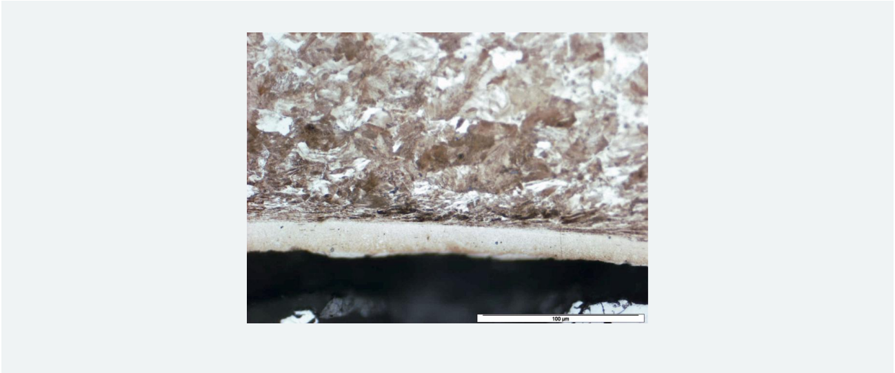
Bild 5: Beispiel einer weißen Schicht auf einer Schienenoberfläche [5]
