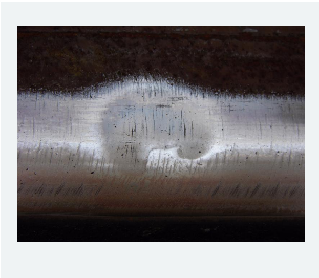
Bild 1: Typischer Squat-Defekt, Nierenform mit V-Riss
