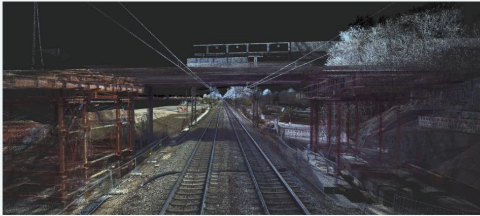
Bild 8: Darstellung einer digitalisierten Strecke mit eingefärbter Punktwolke
