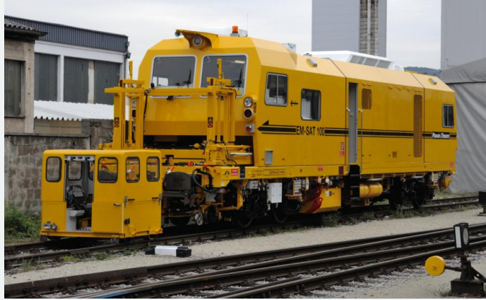
Bild 2: Außenansicht des EM-SAT mit abgesetztem Satellitenfahrzeug
