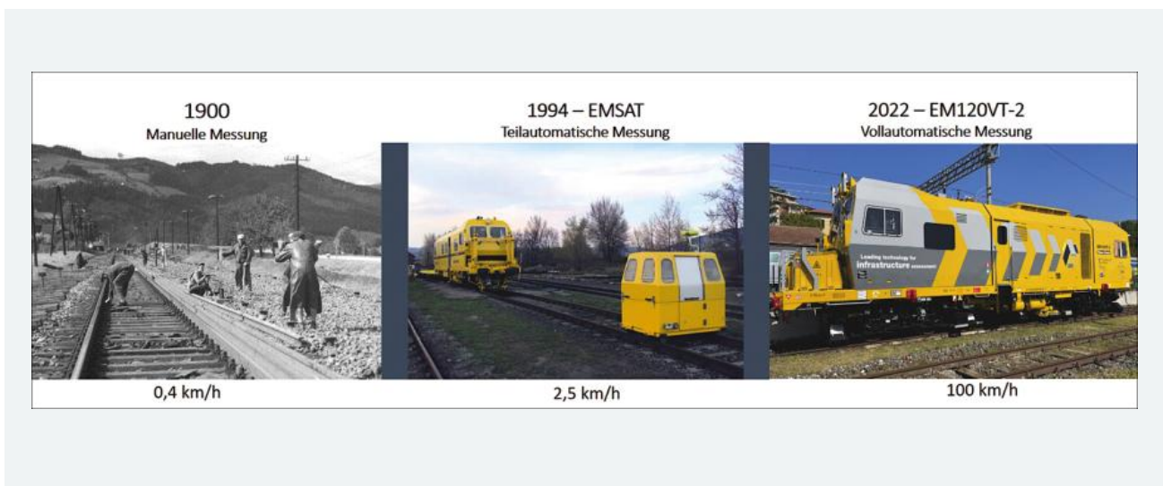
Bild 1: Entwicklung der Geschwindigkeit beim Messen der absoluten Gleislage
