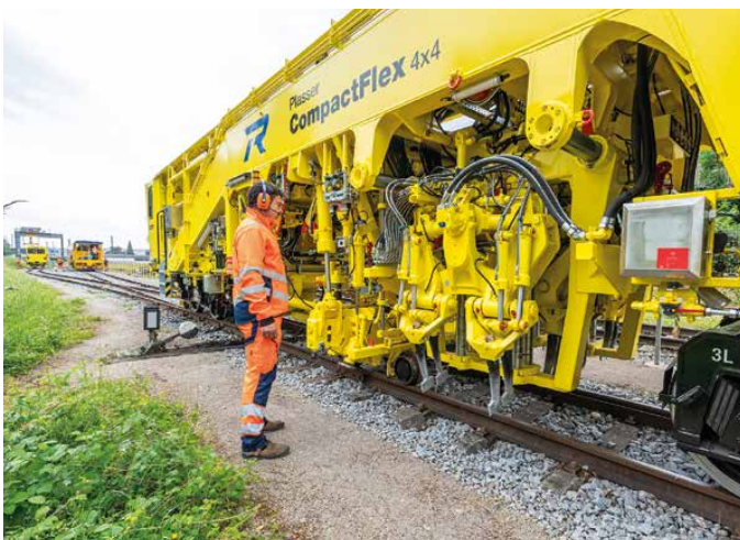
Die Compact-Serie deckt das gesamte Spektrum von Stopfen über Gleisstabilisierung bis Schotterprofilierung ab.
