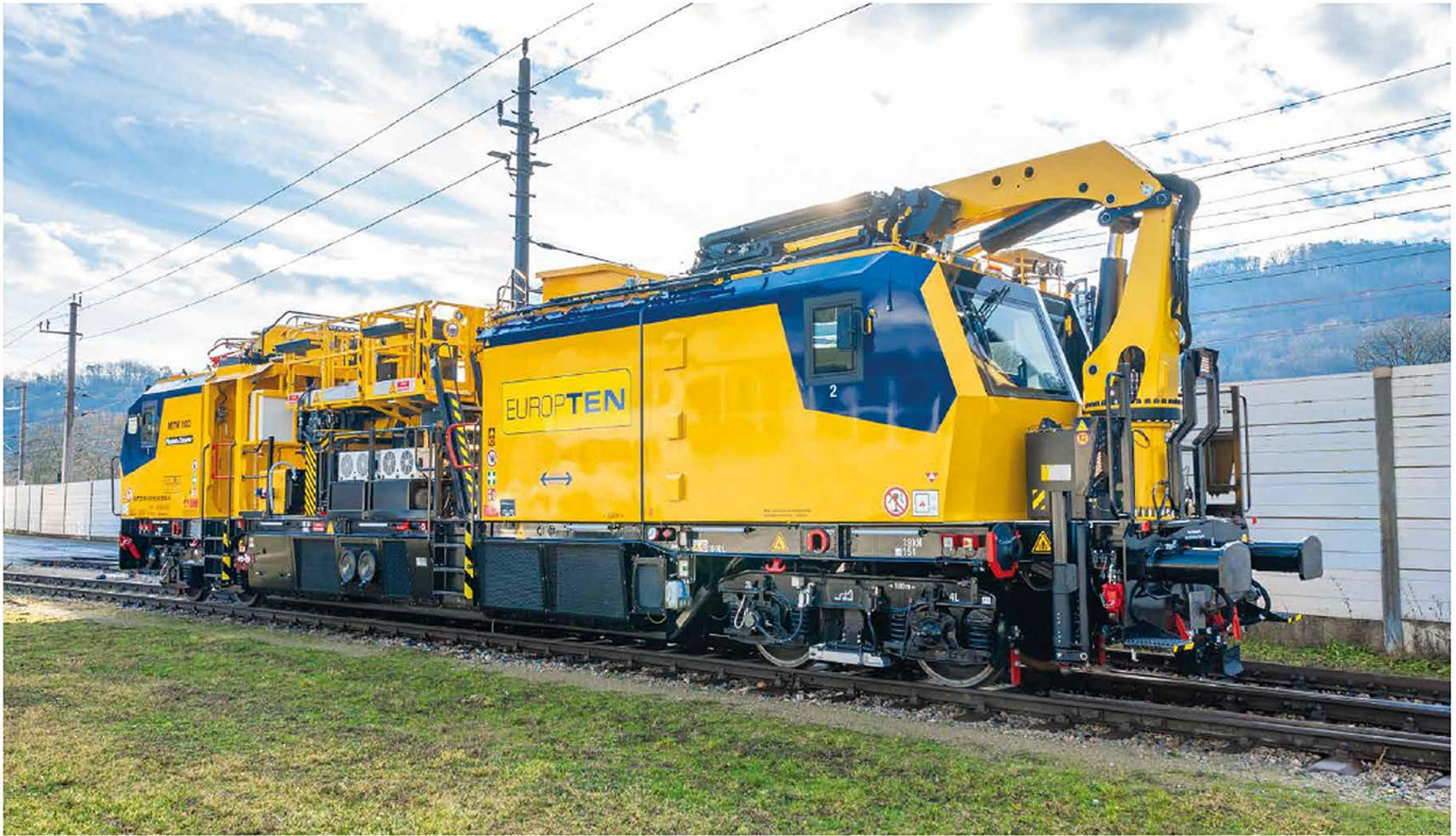
Der MTW 100.216 ist ein universelles Montagefahrzeug für Fahrleitungsbau, -inspektion und -wartung.
