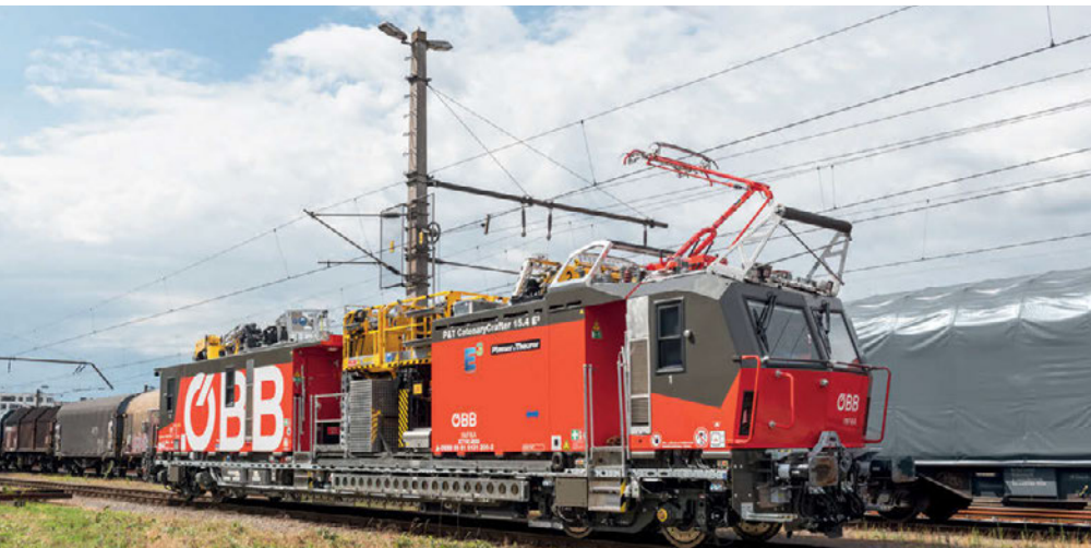
Abb. 2: Streckenfahrt mittels Oberleitung.
