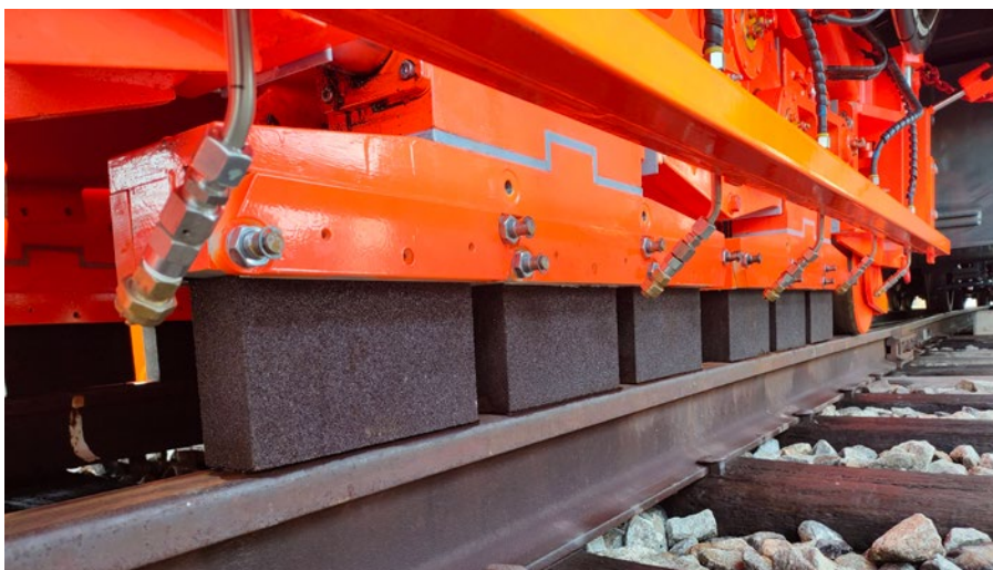
4: Finishing-Einheit mit oszillierender Rutschersteintechnologie zur funkenfreien Nachbearbeitung © ROBEL Bahnbaumaschinen GmbH
