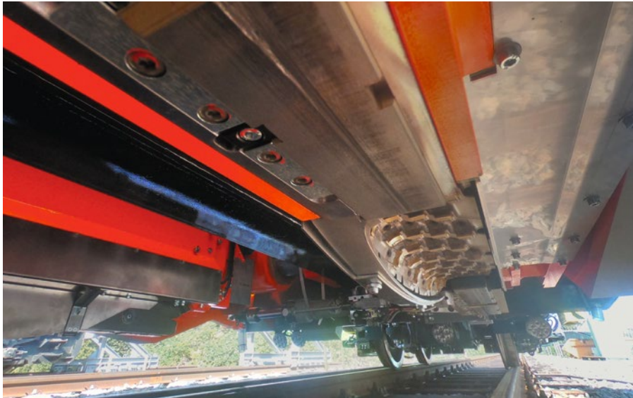
2: Fräseinheit auf dem Schienenbearbeitungssystem Romill Mainline – Ansicht von unten © ROBEL Bahnbaumaschinen GmbH
