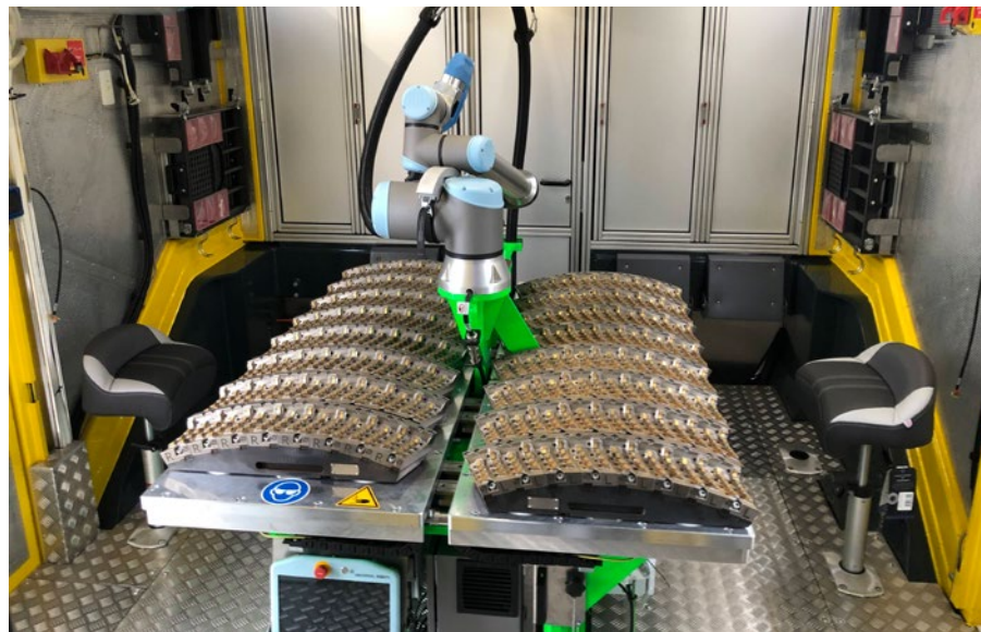
3: Roboter unterstützte Indexierung der Wendeschneidplatten in der maschinenintegrierten Werkstatt © ROBEL Bahnbaumaschinen GmbH
