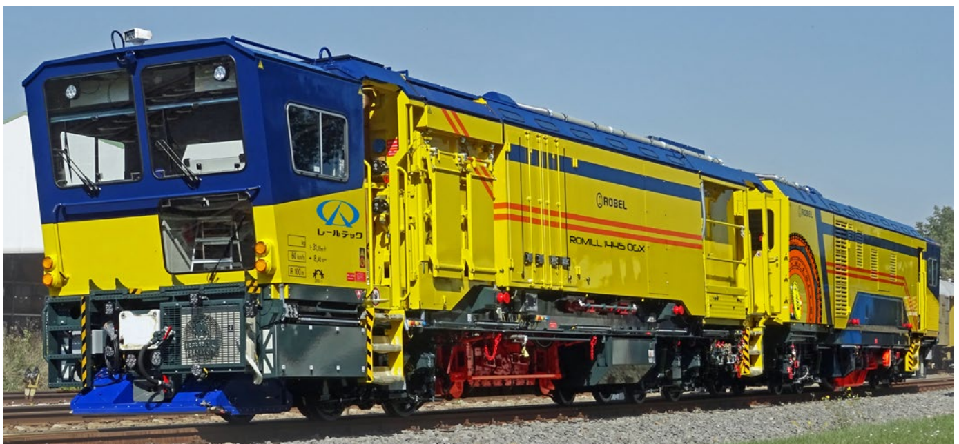
1: Fräsmaschine vom Typ Romill Mainline für den japanischen Markt
