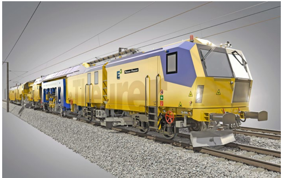
1: Der neue UNIMAT 09-8x4/4S BR Dynamic E 3 vereint die Arbeitsschritte Einschottern, Stopfen, Planieren, Stabilisieren sowie Auf- und Nachmessen in einem Maschinenkonzept
