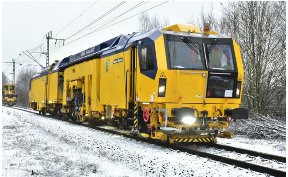
6: Der elektrisch arbeitende Unimat 09-4x4/4S E 3 im Wintereinsatz für Swietelsky bei Flieden in Nordhessen, Dezember 2020
