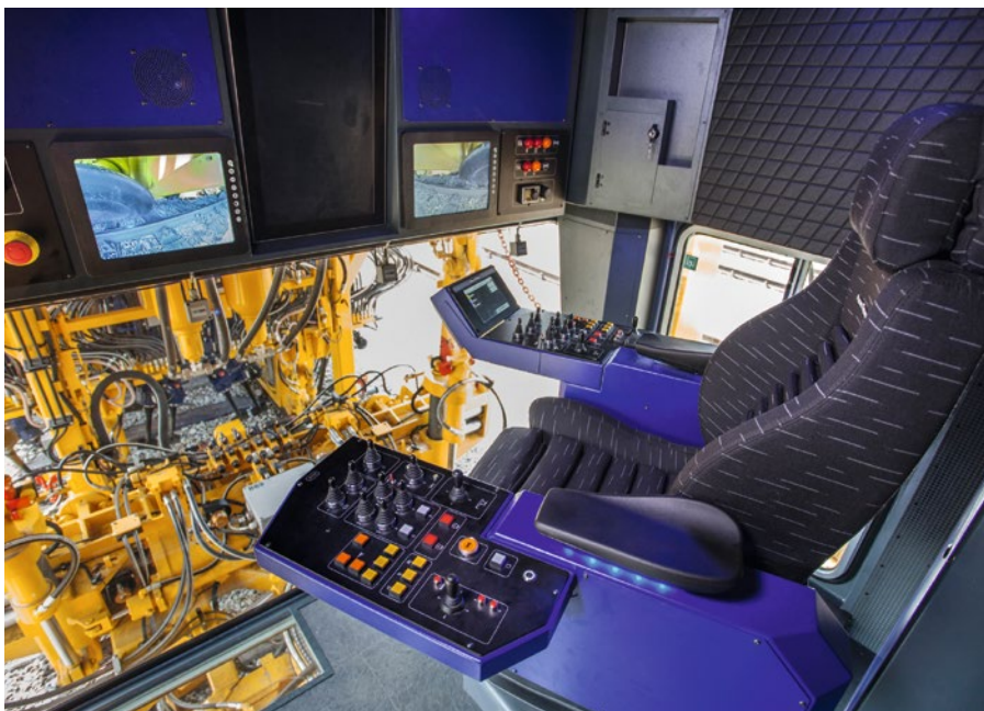
5: Blick auf den Arbeitsplatz des Beistopfers im Unimat 09-4x4/4S E 3
