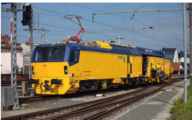
1: Der Unimat 09-4x4/4S E 3 bei Stopfarbeiten unter Fahrdrat im Elektromodus
