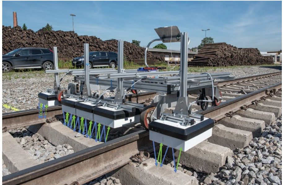
2: Aufbau und prinzipielle Darstellung der aufgezeichneten Kanäle des Multi-Antennen-Radarsystems Quelle der Bilder 2-7: Plasser & Theurer
