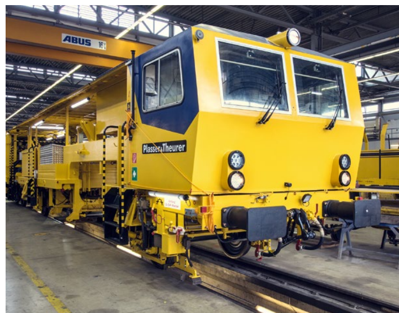
1 und 2: Der Vergleich des Unimat 08-475/4S vor und nach dem Retrofit zeigt schon optisch, wie sehr die Maschine modernisiert wurde
