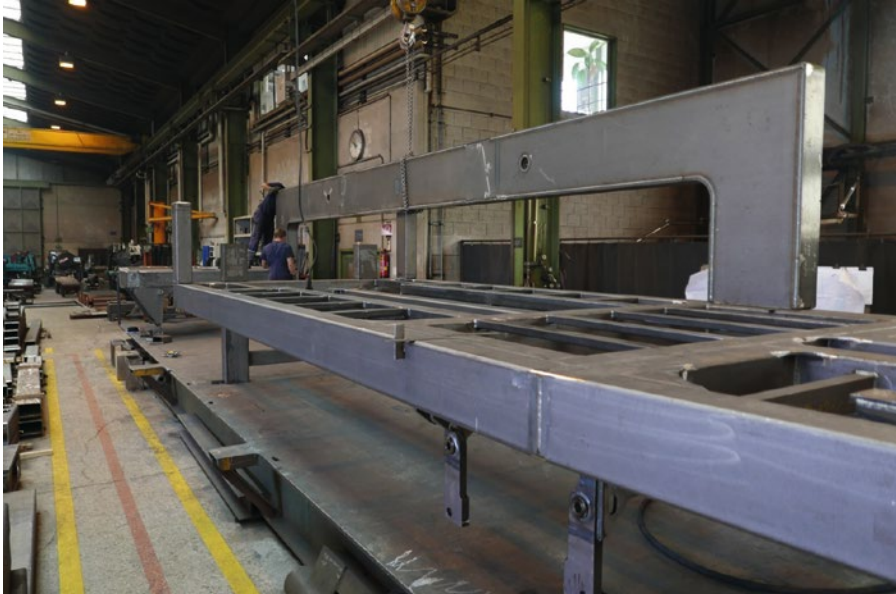
4: Aufgrund des Upgrades vieler Komponenten der Stopfmaschine 08-16/90 musste auch der Hauptrahmen neu konstruiert und gebaut werden. Diese Arbeiten erfolgten bei Plasser & Theurer in Linz und unterstreichen die Bedeutung der engen Zusammenarbeit zwischen Hersteller und Serviceunternehmen
