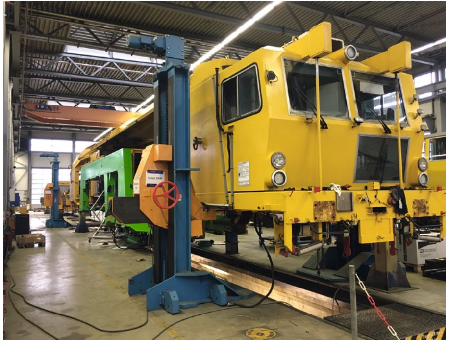
3: Unimat 09-16/4S mit Anhänger. Zu diesem Zeitpunkt waren die Fortschritte bei der Instandsetzung und Modernisierung der Unfallmaschine schon deutlich zu sehen
