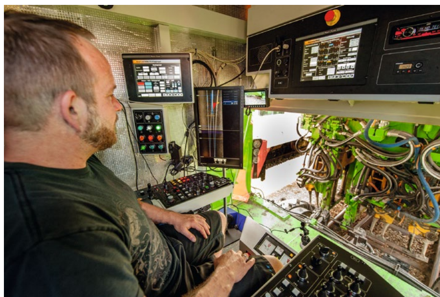
4: Stopfkabine mit dem Assistenzsystem PlasserSmartTamping – The Assistant
