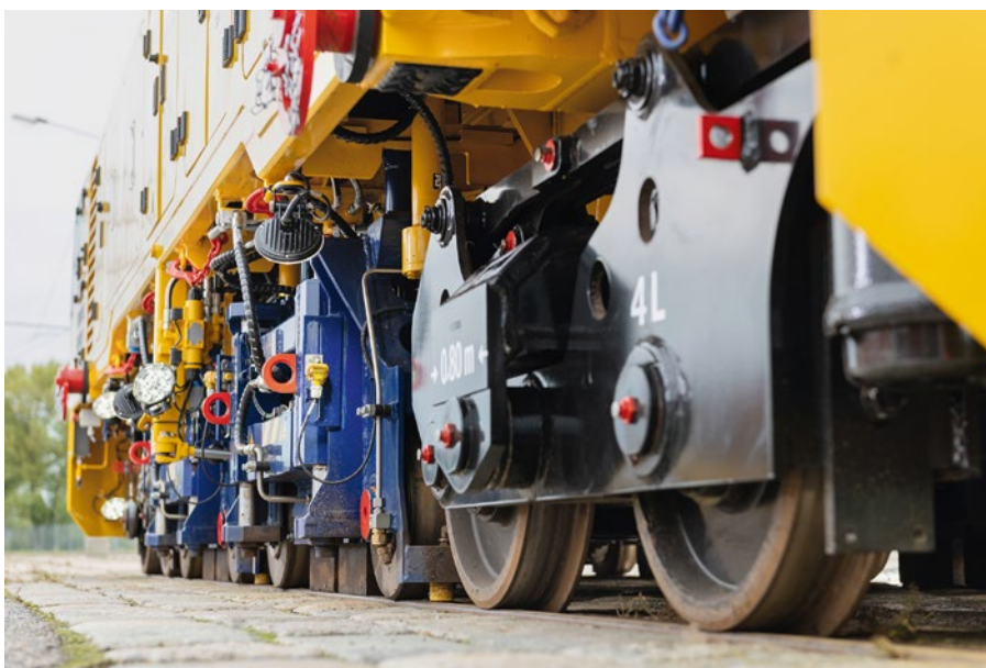
3: Schleifaggregate des oszillierenden Schleifanhängers ATMO
