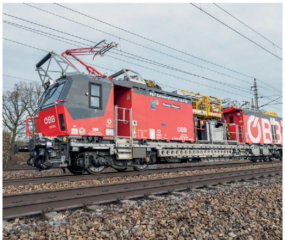
5: Plasser CatenaryCrafter 15.4 E 3 bei Streckenfahrt mittels Oberleitung
