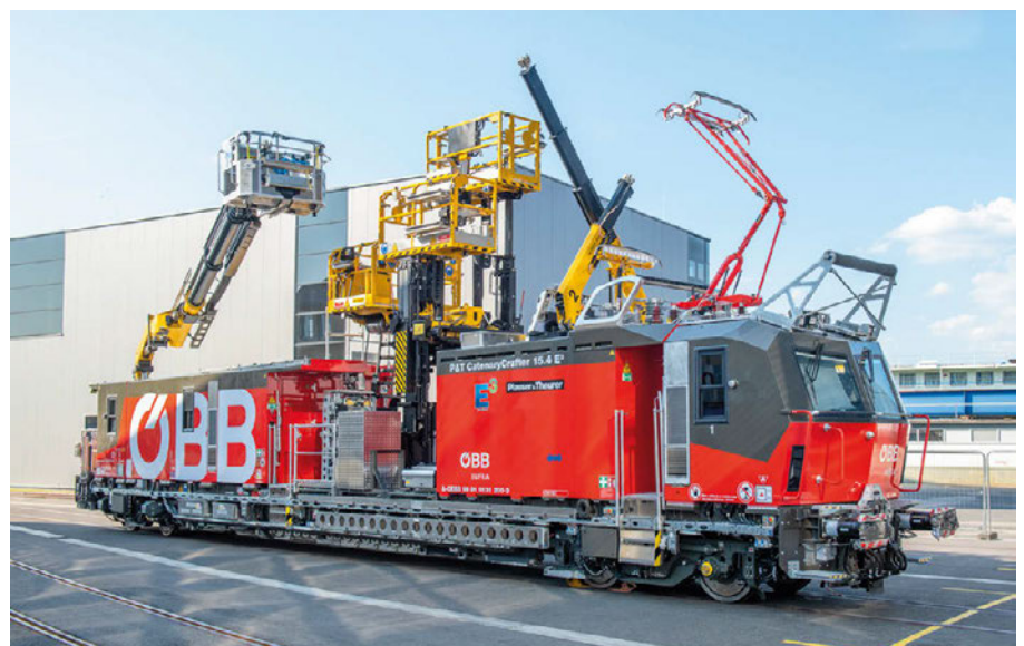
3: Arbeitsaggregate des CatenaryCrafters in ausgefahrenem Zustand
