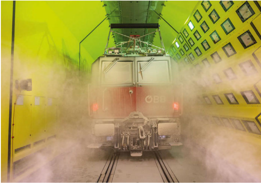
4: Test des Plasser CatenaryCrafter bei härtesten Umgebungsbedingungen in der Klimakammer
