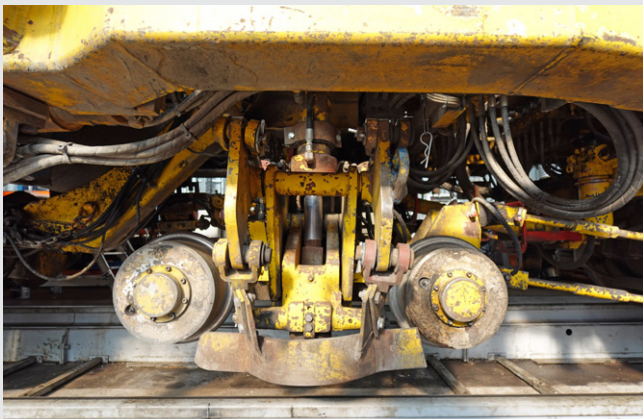
3: Aggregat zur dynamischen Gleisstabilisation vor Aufarbeitung nach vielen Einsatzjahren (links), überholtes Arbeitsaggregat (rechts)
