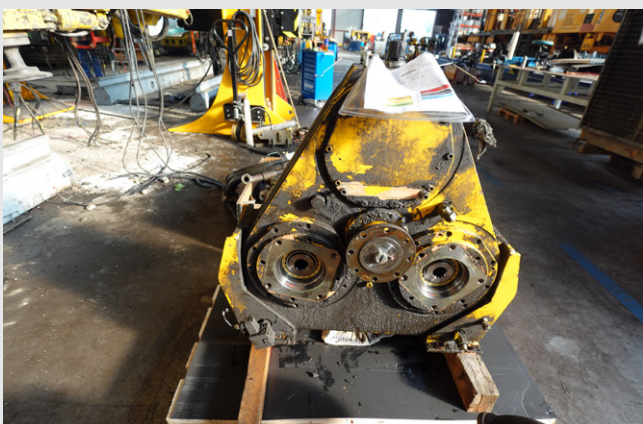
4: Ein im Zuge der Aufarbeitung ausgebautes Pumpenverteiltriebe (links) und in überholtem Zustand wieder im Einsatz (rechts)
