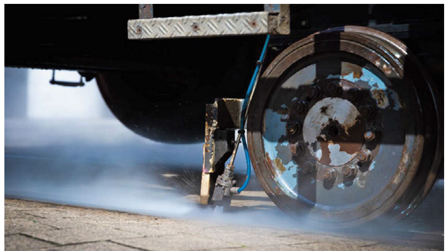
2: Speziell entwickelte Düse zur effizienten Reinigung von Schienenoberflächen
