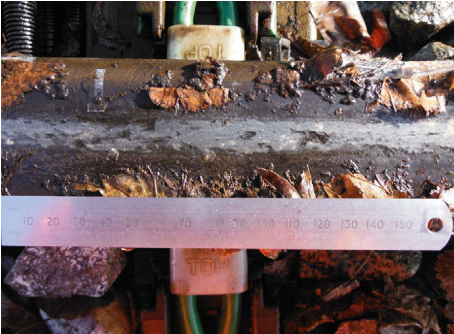
1: Harte Schicht mit geringer Reibung, bestehend aus Blättern auf der Schienenoberfläche
