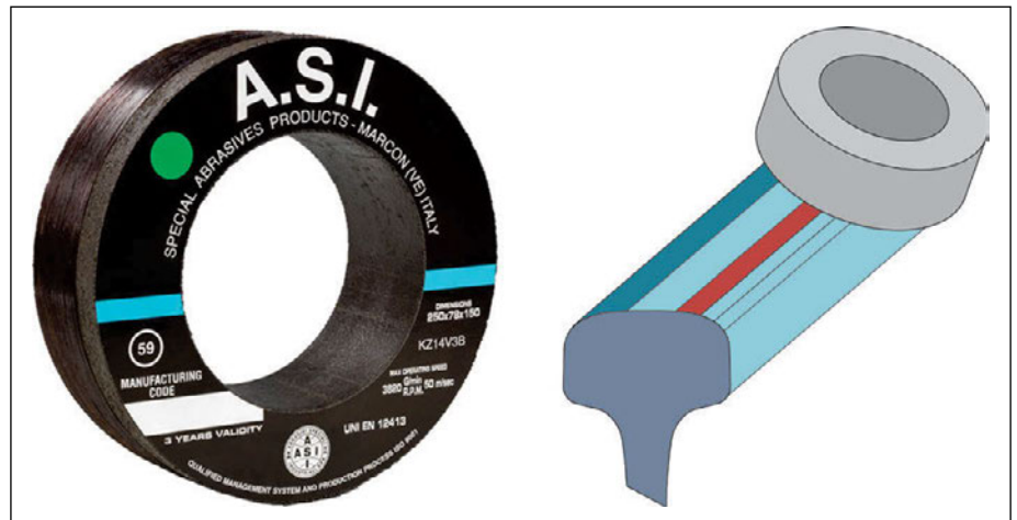
Abb. 1: Links: Topfschleifscheibe, rechts: Facettenbildung durch Schleifscheibe auf Schiene
