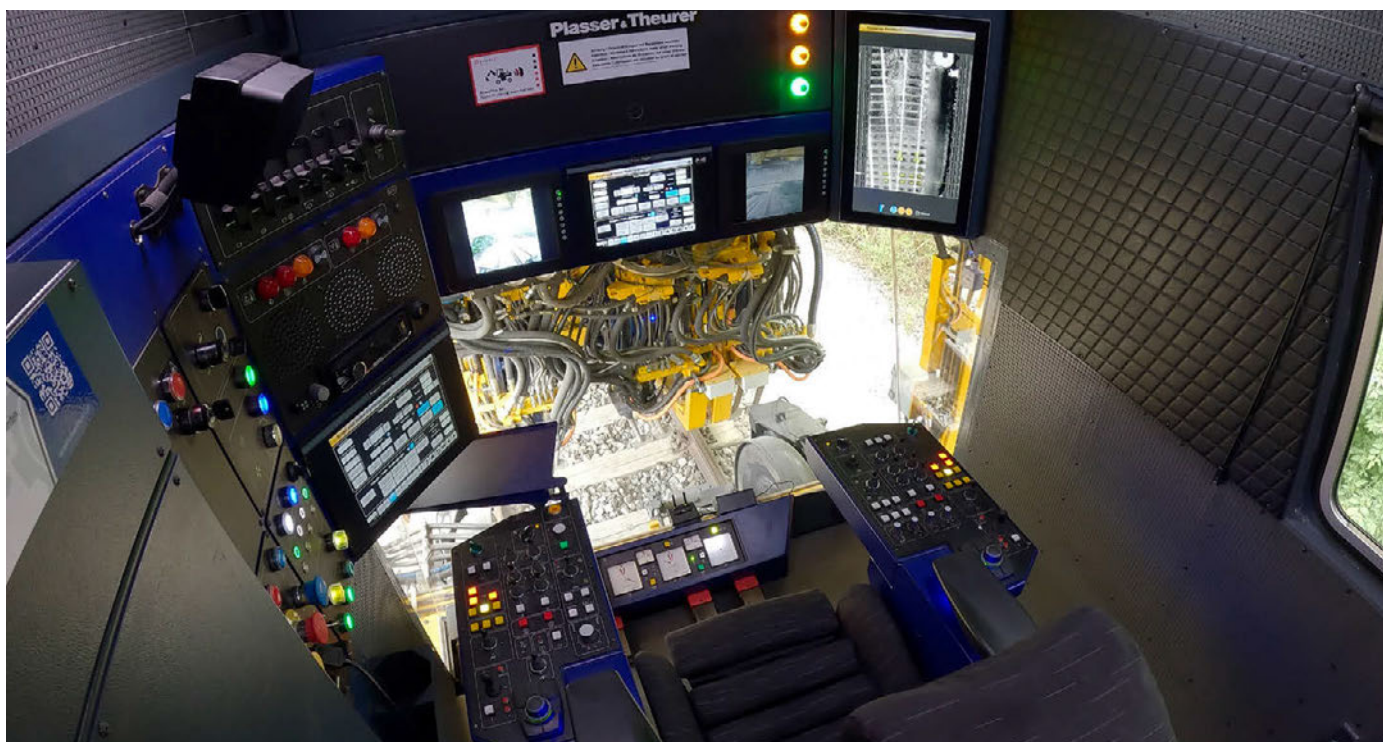
Abb. 5: Autonome Stopfung einer Weiche ohne Bedienpersonal in der Stopfkabine bei einer Vorführung im Rahmen der iaf 2025
