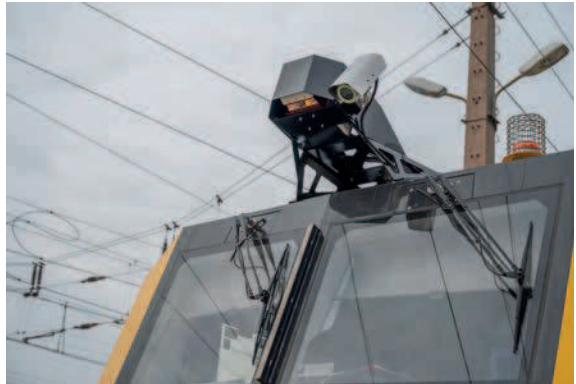
Abb. 5: Installierte LiDAR-Hardware des Plasser TampingAssistant
