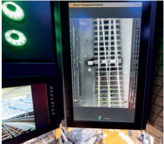
Abb. 9: Bedieneransicht des TampingAssistant in der Stopfkabine
