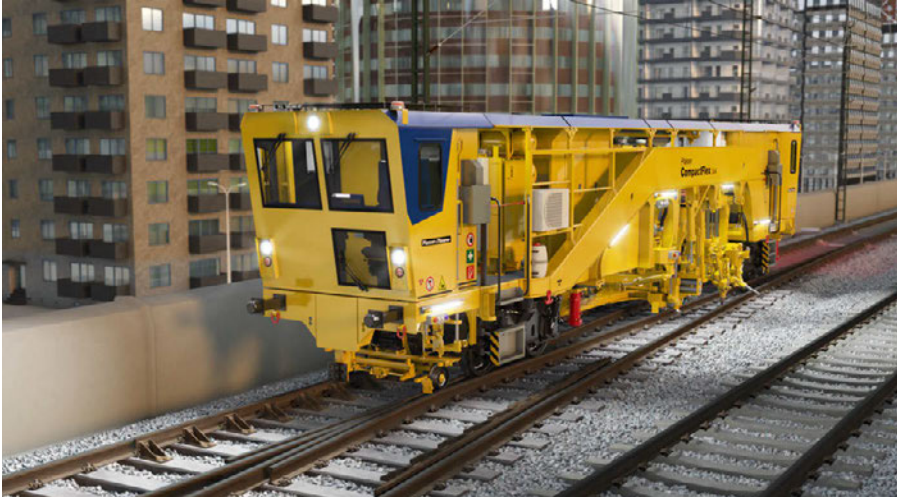
7: Plasser CompactFlex in verladbarer Ausführung mit reduzierter Bauhöhe für die U-Bahn in Busan, Südkorea
