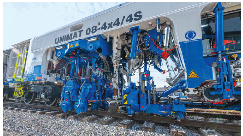
6: Flottenerweiterung in Großbritannien: bewährte 4x4-Flexibilität für Weichen jetzt auch mit elektrischem Stopfaggregat
