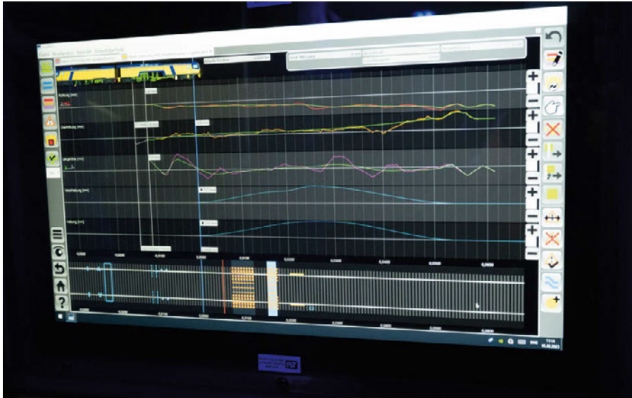
5: Effizientere Bedienung und Abhilfe für Fachkräftemangel: SmartALC mit Hinderniserkennung direkt aus der Stopfkabine
