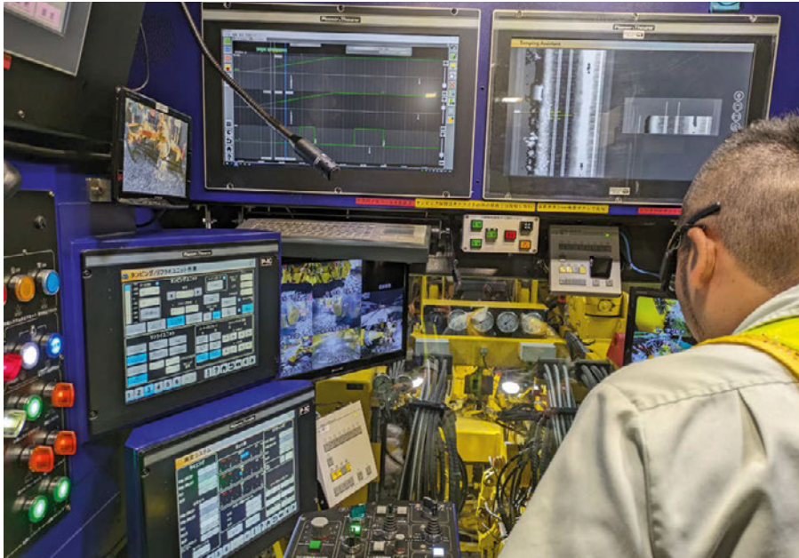
3: Der Plasser TampingAssistant im Einsatz in Japan zeigt eine Übereinstimmung von über 99% beim Vergleich der Handlungsempfehlungen des Assistenzsystems mit der Arbeitsweise erfahrener Maschinenbediener
