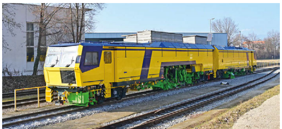
4: Kompakte Komplettlösung für die Instandhaltung von Japans Hauptstrecken mit 1.067 mm Schmalspurgleisen und niedriger Achslast
