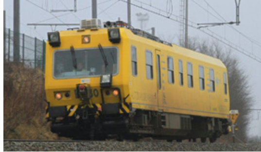
Abb. 7: Messfahrzeug EM 130 von Infrabel
