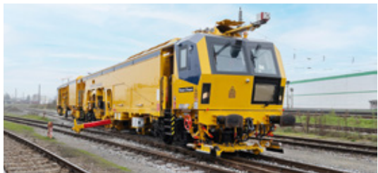
Abb. 11: Der neue Unimat 08-4x4/45 von Infrabel
