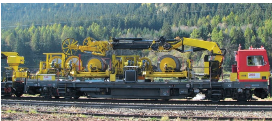
BILD 1: Fahrleitungsumbaumaschine (FUM) von Plasser & Theurer
