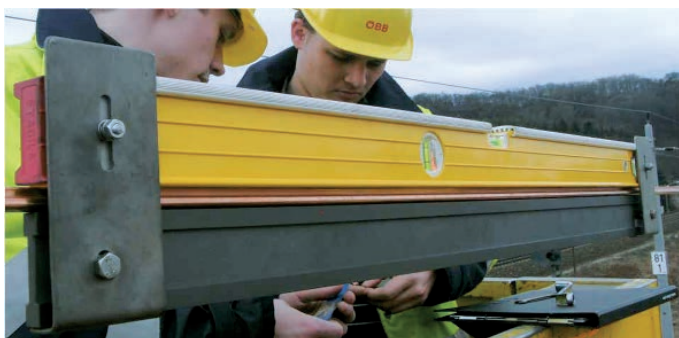
BILD 2: Messung der vertikalen Abweichungen des Fahrdrachtes (Mikrowelligkeit)
