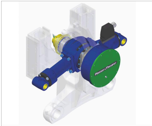
Bild 4: Übersicht Vibrationsantrieb mit regulierbarer Vibrationswelle
