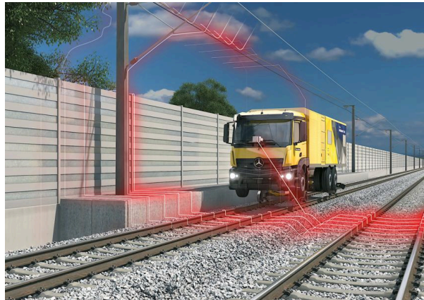
Bild 5: Lichtraumprofilmessung mit dem InfraSpector Truck
