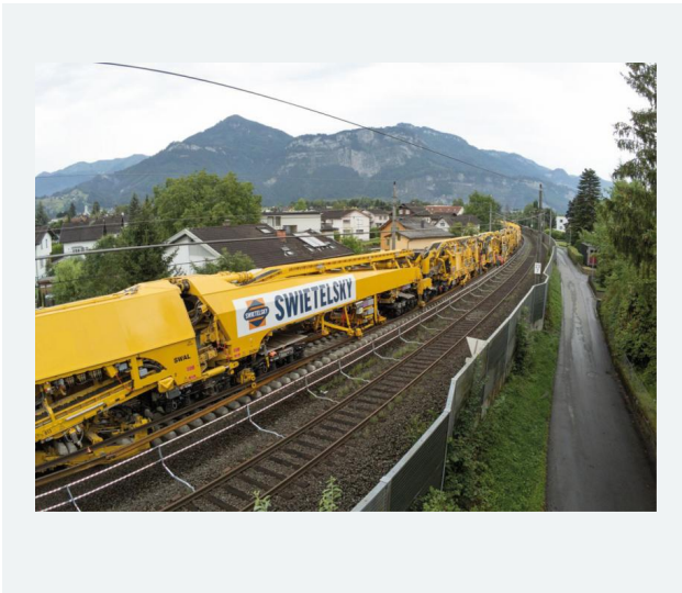
Bild 1: Die neue Maschine RUS 1000 S inklusive Materialwagen
