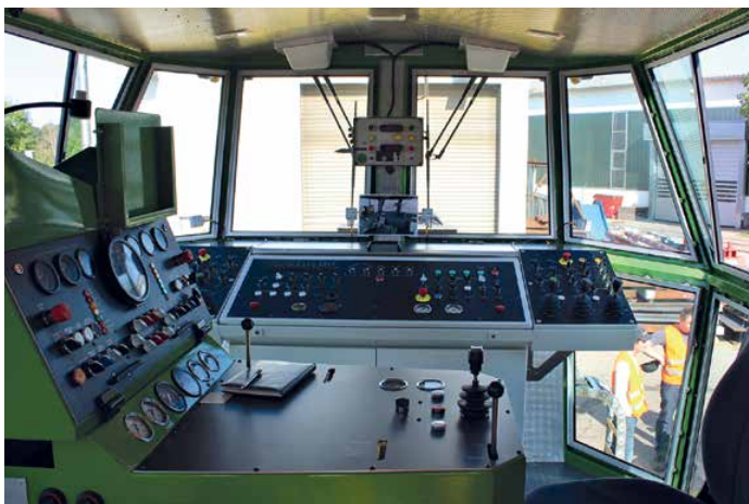
Im Lauf des Jahres 2019 wurde bei der Robel Bahnbaumaschinen GmbH eine Schnellschotterverteiler- und Planiermaschine (SSP) des Gleisbauunternehmens H.F. Wiebe für viele weitere Einsatzjahre ertüchtigt. Die Maschine wurde im Rahmen des Retrofit-Programms nicht nur grundlegend aufgearbeitet (links oben), sondern erhielt auch eine neue Kabine mit einem erneuerten Fahr- und Arbeitspult (links unten) sowie zahlreichen neuen Fenstern für einen noch besseren Rundumblick über die Baustelle (rechts).
