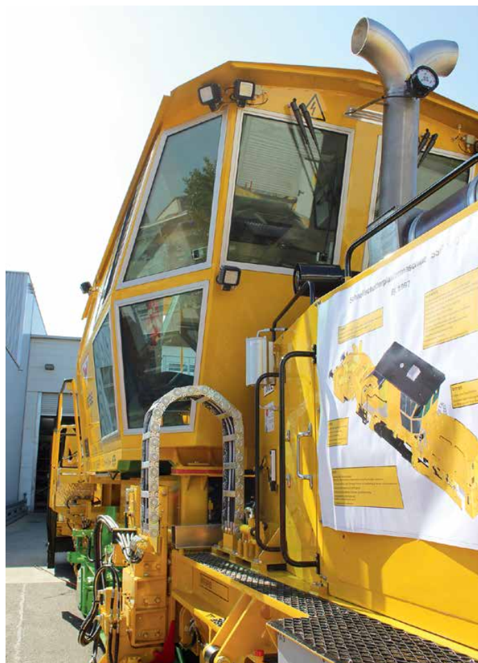
Im Lauf des Jahres 2019 wurde bei der Robel Bahnbaumaschinen GmbH eine Schnellschotterverteiler- und Planiermaschine (SSP) des Gleisbauunternehmens H.F. Wiebe für viele weitere Einsatzjahre ertüchtigt. Die Maschine wurde im Rahmen des Retrofit-Programms nicht nur grundlegend aufgearbeitet (links oben), sondern erhielt auch eine neue Kabine mit einem erneuerten Fahr- und Arbeitspult (links unten) sowie zahlreichen neuen Fenstern für einen noch besseren Rundumblick über die Baustelle (rechts).
