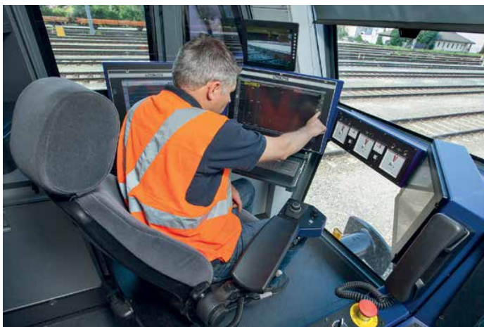
Oben: Premiere hatte der neue Unimat 09-4x4/4S E 3 im Mai 2017 auf der Internationalen Ausstellung Fahrwegtechnik (iaf) in Münster. Links: Alles im Blick hat der Maschinenführer, dessen Arbeitsplatz sich »vorne links« in der neu gestalteten Kabine befindet. Rechts: Das Vierfachstopfaggregat im Detail – anstelle von Öldruckschläuchen für die Hydraulik verlaufen hier nun isolierte Elektrokabel.
