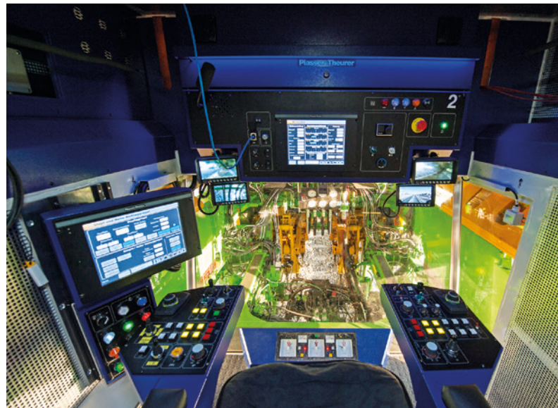
BILD 3: Ergonomisch nach neuesten Gesichtspunkten gestaltete Kabine des Dynamic Stopfexpress 09-4X E 3
