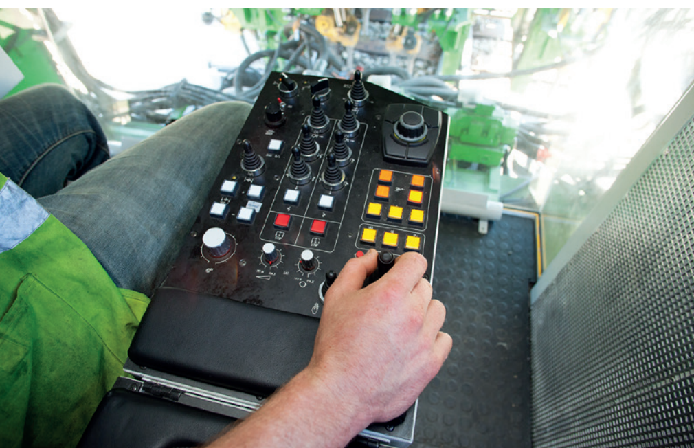
BILD 4: Alle für den Arbeitsprozess relevanten Schalter wurden in der Armlehne des Sitzes positioniert. Die Touchpanels können wahlweise auch über einen Display-Controller bedient werden
