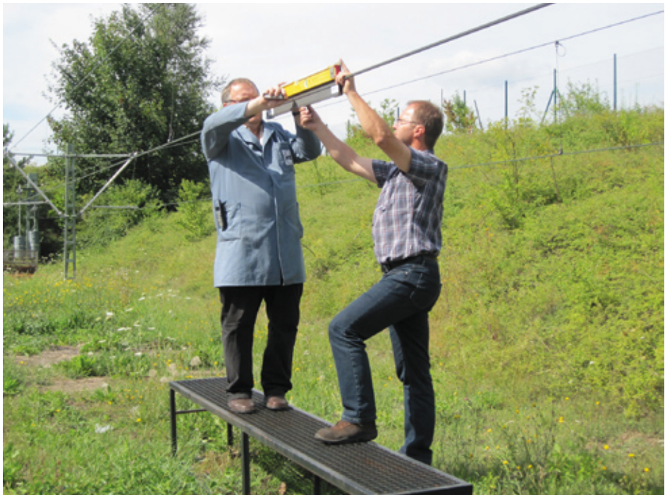
Abb. 4: Ermittlung des Spaltmaßes von Versuchsmaterial RIM 120 im nkt cables-Oberleitungsversuchsfeld (Re330 mit Originalbauteilen der DB) in Hettstedt
