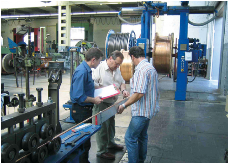
Abb. 2: Ermittlung des Spaltmaßes von Versuchsmaterial RiM 120 auf einer Kabelumwickelanlage bei nkt cables in Köln
