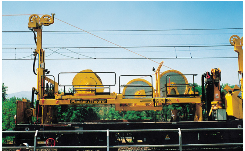
Bild 2: Fahrleitungs-Installationsmaschine (FUM) (Foto: Plasser & Theurer).
