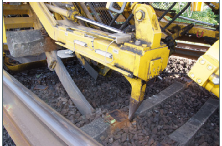
BILD 7: Altschwellenaufnahme des SUZW 500
