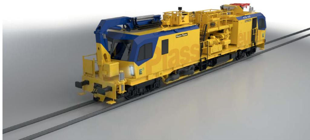
Abb. 2: Fahrleitungsinstandhaltungsmaschine HTW 100 E<sup>3</sup>
