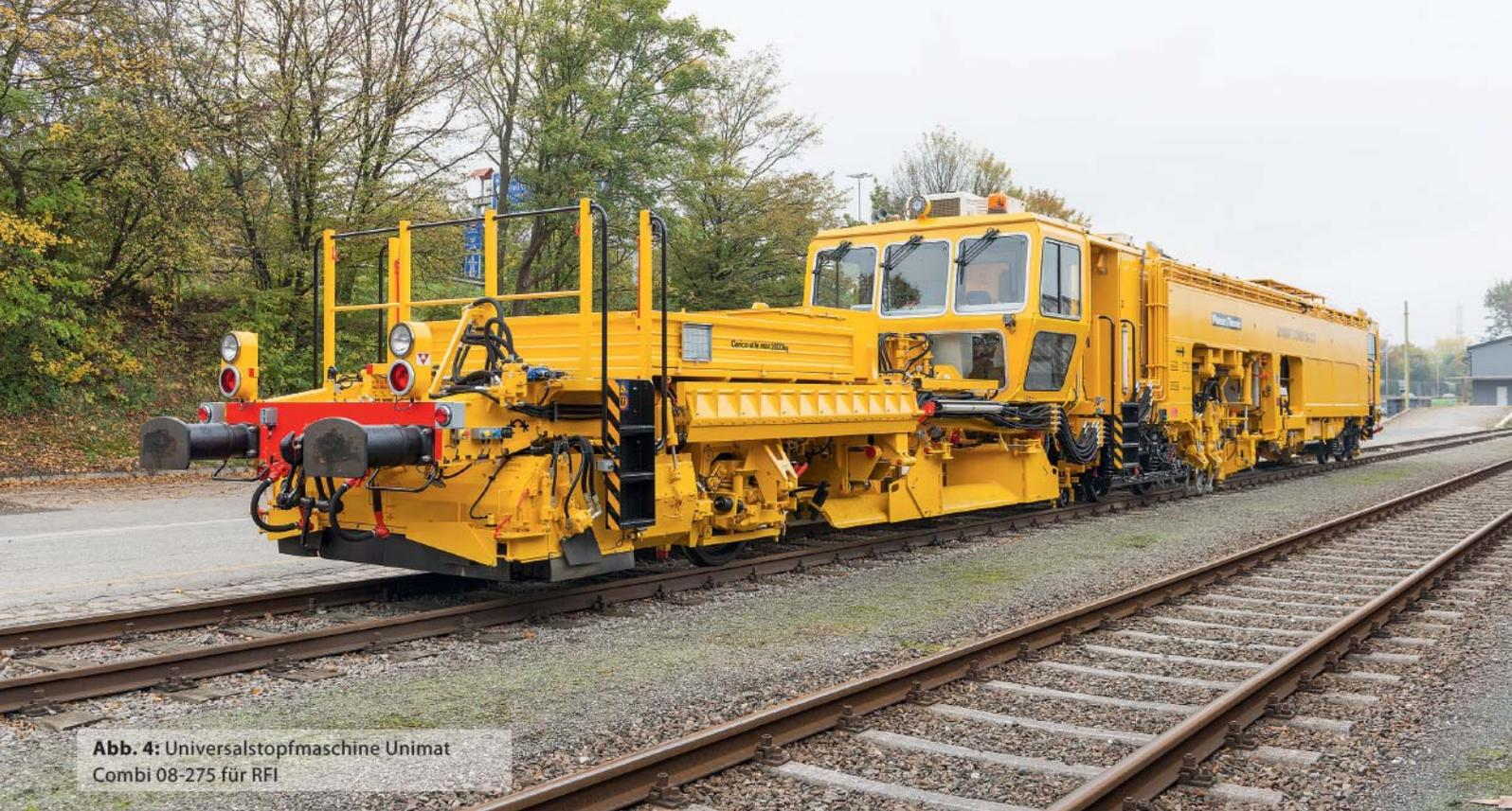
**Abb. 4:** Universalstopfmaschine Unimat Combi 08-275 für RFI
