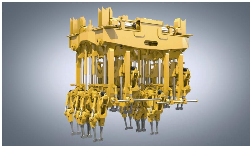
Abb. 3: 8x4-Stopfaggregat auf der Ausstellung InnoTrans 2016
