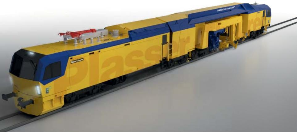
**Abb. 1:** Universalstopfmachine für vollelektrischen und diesel-elektrischen Betrieb
