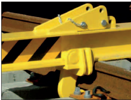
Abb. 3: Schienenzange am Rahmentragwerk (links) – Anschlagmittel an Traverse (rechts)
