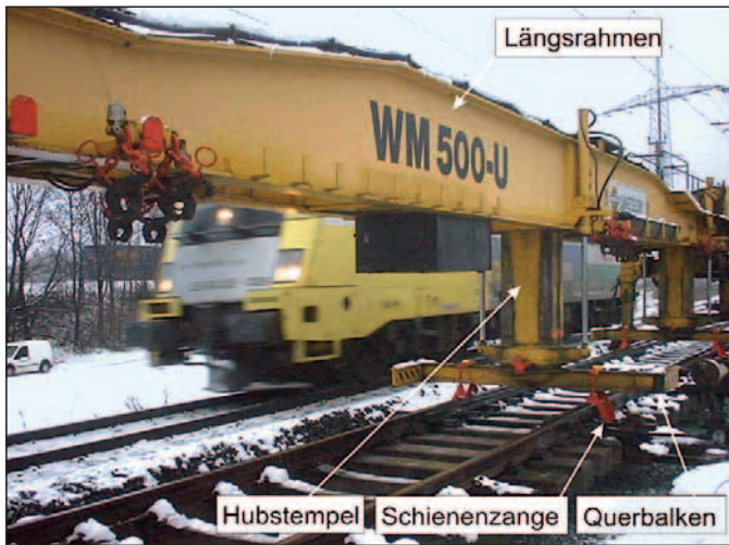
Abb. 5: Konstruktion Portalkran PK1 der Serie WM 500 (links und rechts)
