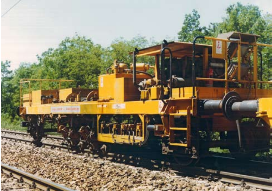
Abb. 4: Der erste Dynamische Gleisstabilisator, als Stopfmaschinen-Anhänger ausgeführt
