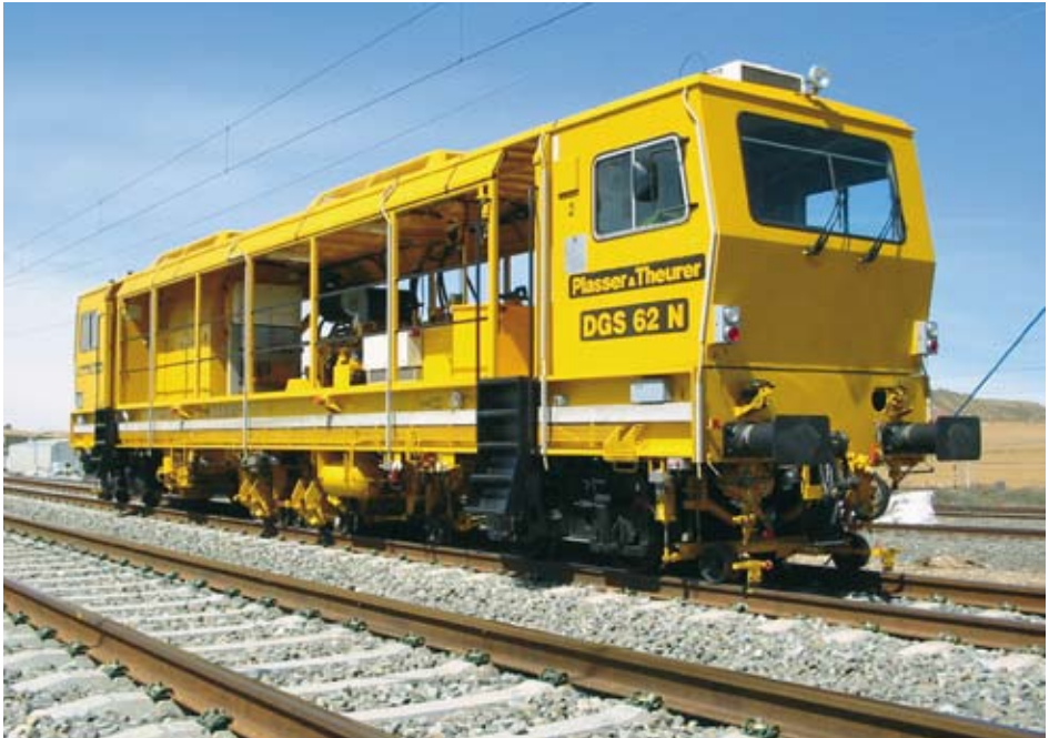
Abb. 7: Die vierachsige Standardausführung DGS 62 N
