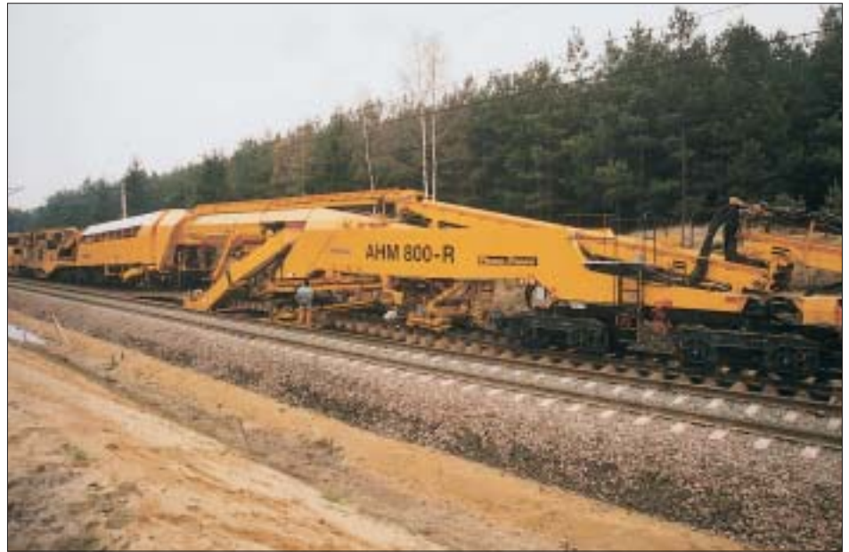
Bild 3: Planumsverbesserungsmaschine AHM 800-R PL zum Einbau einer PSS ohne Demontage des alten Gleisrostes
