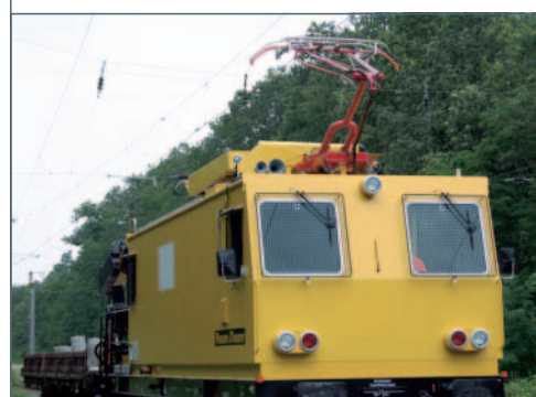
BILD 6: Abnahmemessung der Oberleitung bei einem praktischen Einsatz auf dem Netz der DB AG
