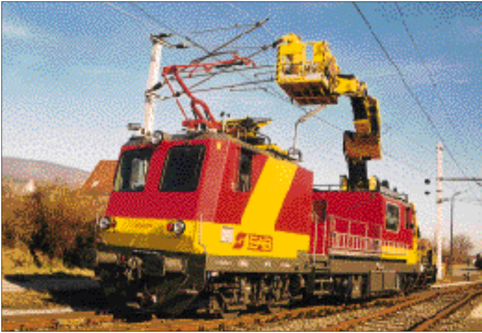
Bild 6: Fahrleitungs- bau- und Instandhal- tungsmaschine MTW 100.083/1
