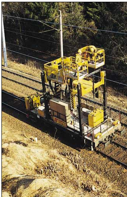
Abb. 1: Motorgerüstwagen FGW 10 mit dreiteiliger Arbeitsbühne
