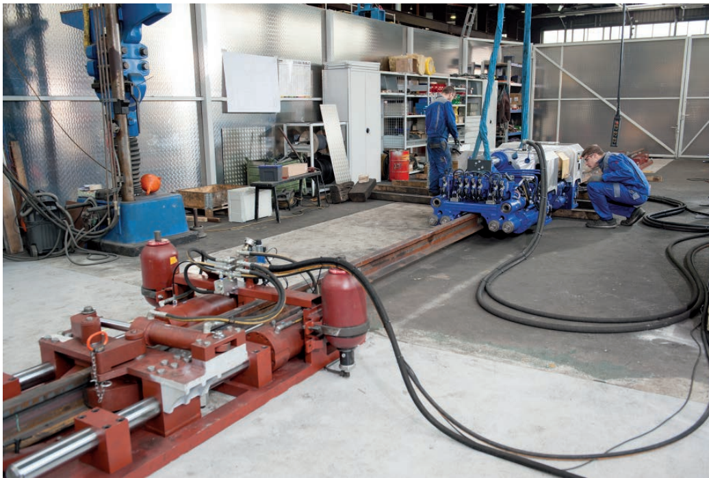
BILD 4: Verspannprüfstand zur Simulation eines temperaturbezogenen Längenausgleichs
