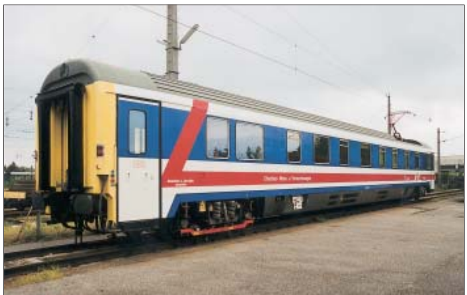
Bild 2: Gleismessfahrzeug EM 250 der Österreichischen Bundesbahnen — seit Beginn des Jahres 2000 ist das GPS-unterstützte Standort-synchronisationssystem in Verwendung.
