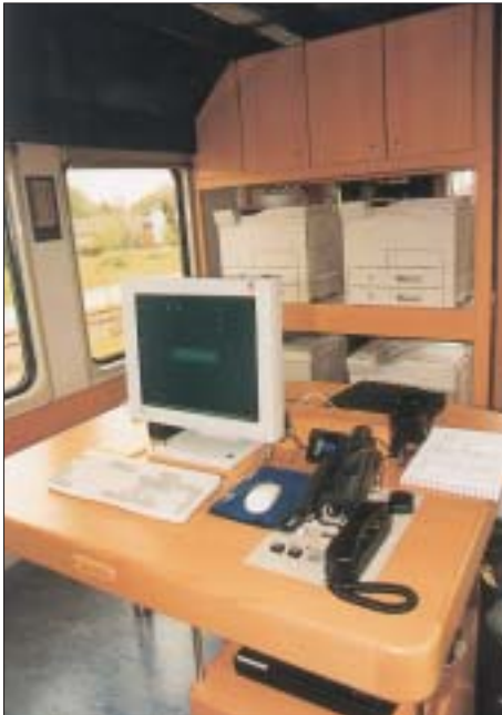
Bild 3: Arbeitsplatz des Messfahrzeuges EM 250 – im Hintergrund ein Tastenpult zur Eingabe von Ereignismarkierungen.
